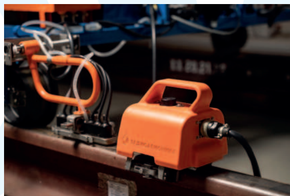
Подключение сканирующего устройства для оценки размеров дефекта
